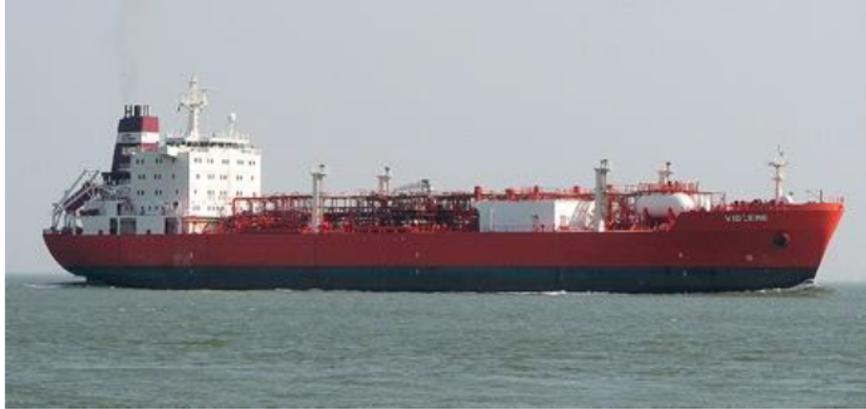
Figure 17. Un exemple de transporteur de GPL totalement réfrigéré.
