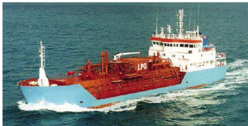
**Figure 16. Un exemple d'un transporteur de GPL/NH<sub>3</sub> semi-pressurisé**
