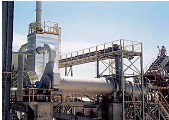
Les tailles standards des sécheuses sont basées sur les taux d'évaporation d'une ou plusieurs tonnes par heure. Le séchage résulte en une réduction de volume des déchets à éliminer mais n'a pas d'autres avantages.
