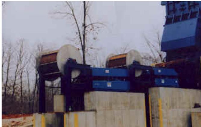
Les aimants autonettoyants de recyclage sont des aimants permanents utilisant les derniers et les plus purs matériaux adaptés pour ce type de système. En comparaison avec les électro-aimants aucune source électrique n'est nécessaire, ils sont nettement plus léger en poids, ont un profile plus bas, ne nécessitent virtuellement aucune maintenance et sont moins cher à acheter, installer et utiliser.
