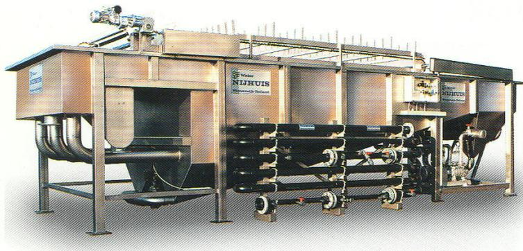
Une unité DAF peut être équipée avec un pack de plaques (comme décrit dans la section 3.3.3) pour augmenter encore l'efficacité de la séparation et ainsi réduire encore son empreinte.
