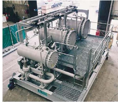
L'efficacité des Hydro cyclones est pauvre dans les fluides visqueux avec des composants ayant peu de différence de densité. Les hydrocyclones sont communément utilisés dans l'industrie pétrolière (on- et offshore) pour la séparation des solides ou de pétrole de l'eau. Les unités montrées sur les images ci-dessus contiennent un certain nombre de hydrocyclones dans chaque navire, afin d'augmenter la capacité du traitement et/ou l'efficacité de la séparation.
