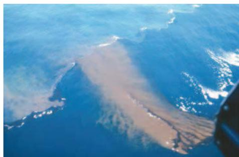
Figure 26 : Au passage de la vague sur la nappe traitée, le pétrole se met en suspension : apparition du nuage beige.
