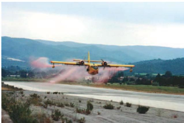
**Figure 2 : Essais au sol de calibrage de l'épandage - Expérimentation PROTECMAR**
