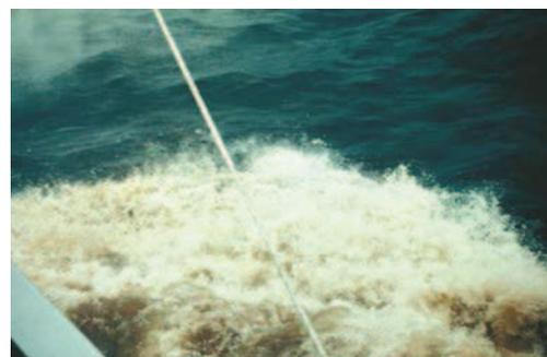
Figure 25 : Essai de dispersion. *Noter la coloration beige au niveau de la nappe, ponctuelle juste après le traitement, et soutenue après l'agitation réalisée à la lance-incendie.*
