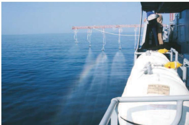
**Figure 3 : Rampe d'épandage en action**
