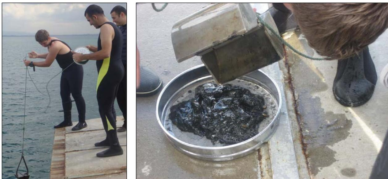
**Fig. 7 & 8 – Prélèvement des échantillons avec une benne à sédiments Shipeck.**
