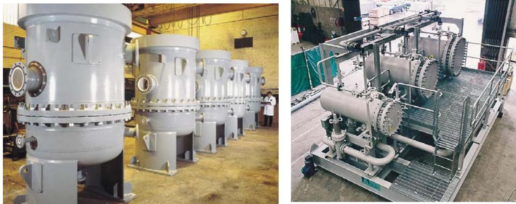
L'efficacité des Hydro cyclones est pauvre dans les fluides visqueux avec des composants ayant peu de différence de densité. Les hydrocyclones sont communément utilisés dans l'industrie pétrolière (on- et offshore) pour la séparation des solides ou de pétrole de l'eau. Les unités montrées sur les images ci-dessus contiennent un certain nombre d'hydrocyclones dans chaque navire, afin d'augmenter la capacité du traitement et/ou l'efficacité de la séparation.
