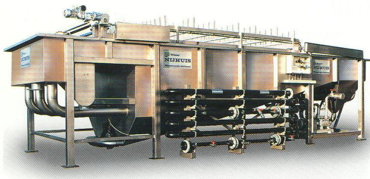
Une unité DAF peut être équipée avec un pack de plaques (comme décrit dans la section 3.3.3) pour augmenter encore l'efficacité de la séparation et ainsi réduire encore son empreinte.
