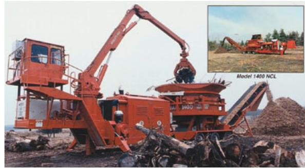
L'équipement peut être manipulé par un opérateur et consiste en une broyeuse à grande vitesse conçue pour réduire rapidement les déchets (puissance du moteur 1.5kW – 300kW)
