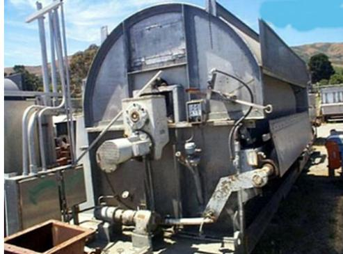
Un filtre sous vide consiste en un cylindre troué couvert d'un milieu filtrant composé de textiles, plastiques ou acier. Tandis que le cylindre tourne, un vide est appliqué à une section du cylindre immergé dans la boue humide. En augmentant le vide, l'eau est envoyée à travers le milieu filtrant, laissant la boue sous la forme d'un gâteau qui est déchargé après une révolution.
