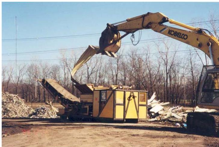
Il y a différents modes possibles tels arbre seul, haut moment de torsion, cisaillement lent de déchiquètement pour la réduction de taille de matériel emballé, ou deux arbres, haut moment de torsion, cisaillement lent de déchiquètement pour la réduction de taille des déchets généraux. (moteur électrique puissance 15kW - 320kW).
