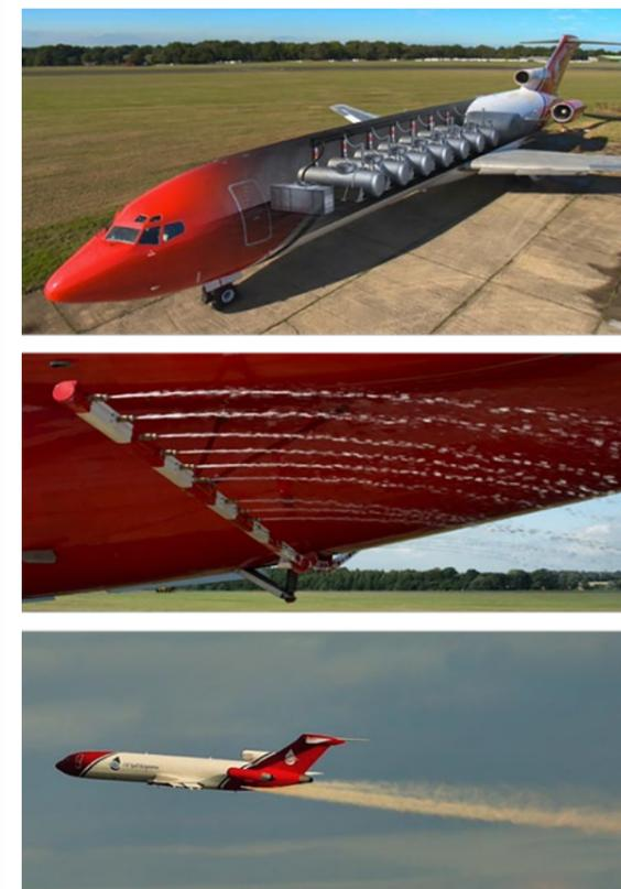
Figure 19. Système de dispersion TERSUS (©OSRL).
