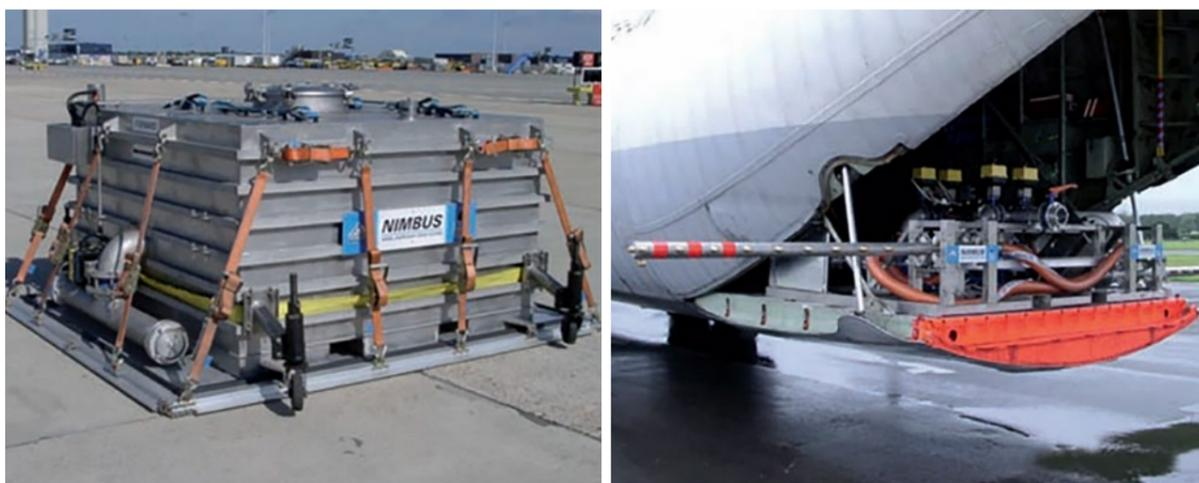
Figure 22. Système NIMBUS L-382 par Ayles Fernie (© Ayles Fernie).
