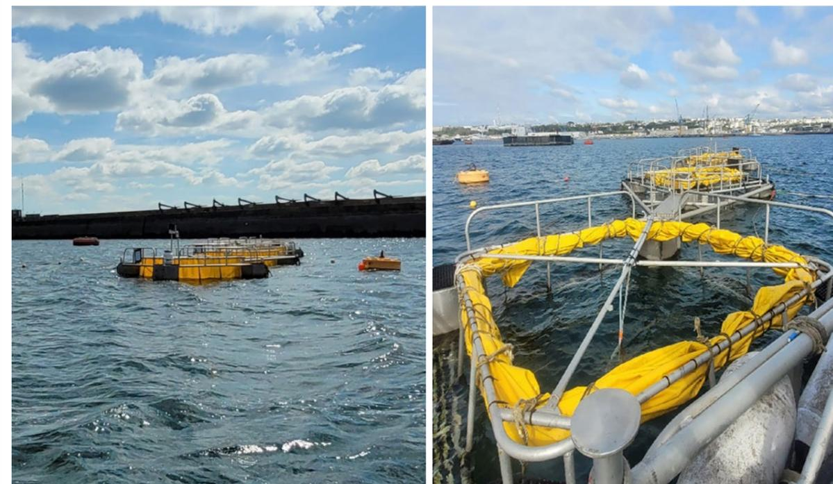
Figure 11. Cellules flottantes utilisées par le Cedre pour des tests en conditions réelles (@Cedre). Objectif : réaliser des tests dans les conditions naturelles.
