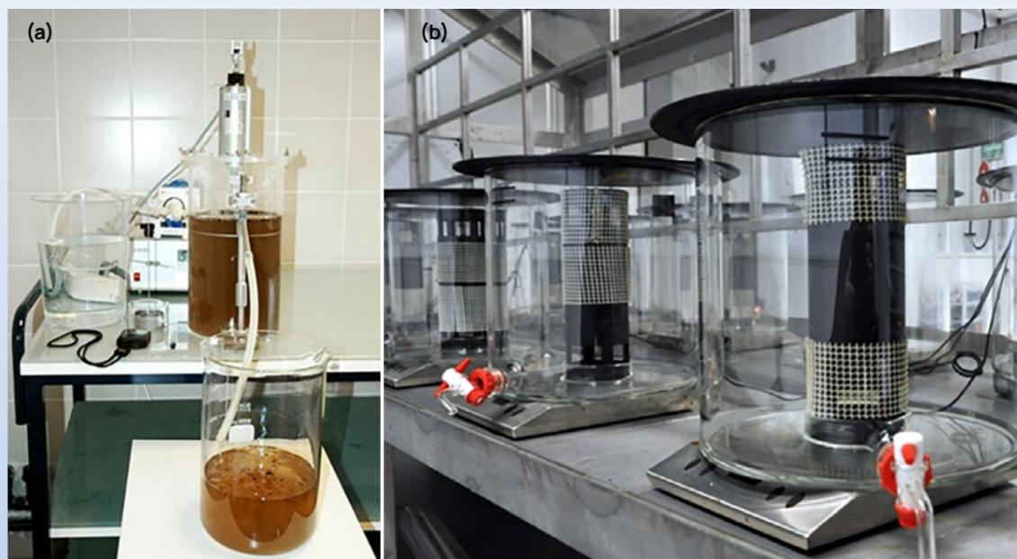
Figure 9. Équipements utilisés en France pour mesurer a) l'efficacité des dispersants (test IFP) et b) leur toxicité (©Cedre).
