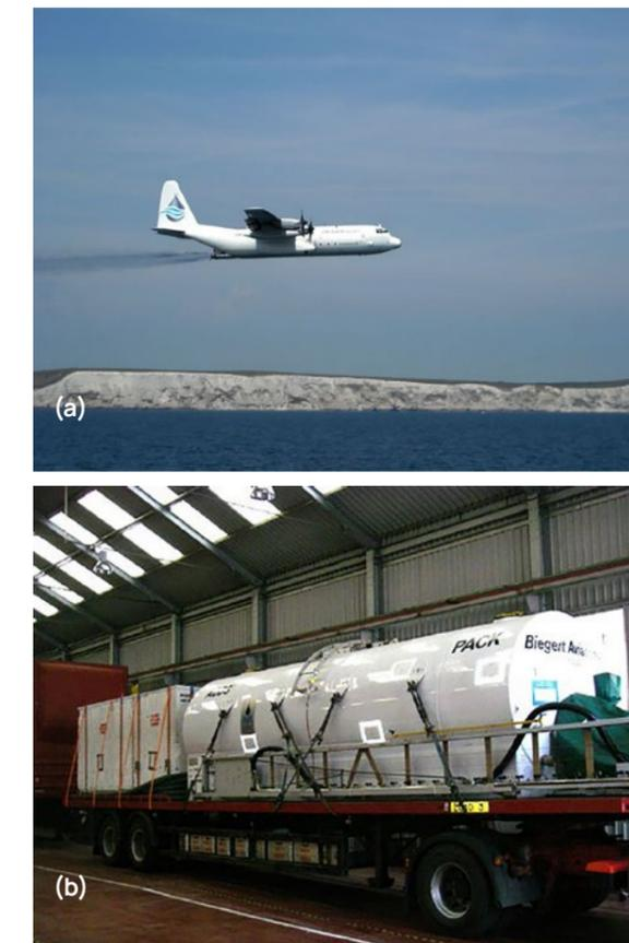
Figure 20.a) Application de faux dispersant (eau) par l'aéronef Hercules d'OSRL équipé d'un pack ADDS ; et b) Système de livraison de dispersant aéroporté (Biegert Aviation Inc.) (©Cedre).
