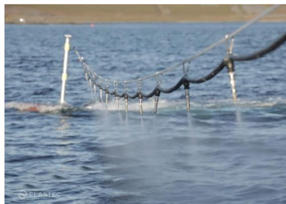
Figure 26. Rampe montée sur paravane (© Elastec).
