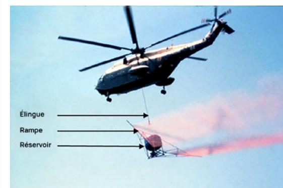
Figure 23. Hélicoptère lourd Super Frelon de la Marine française équipé d'un système à cuve (© Cedre).
