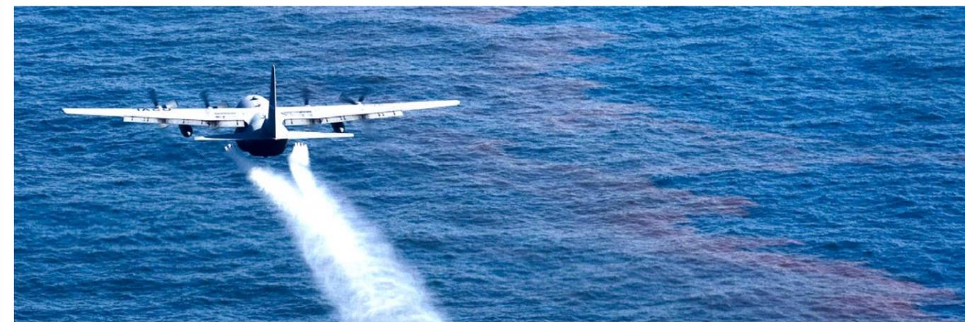
Figure 5. Un avion C-130 de l'U.S. Air Force qui épand des dispersants chimiques à la surface dans le cadre de l'intervention à la suite de l'accident de Deepwater Horizon (@ photo de l'US Coast Guard)
