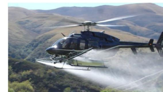
Figure 24. Systèmes d'épandage fixes pour hélicoptère (© Dart Aerospace).
