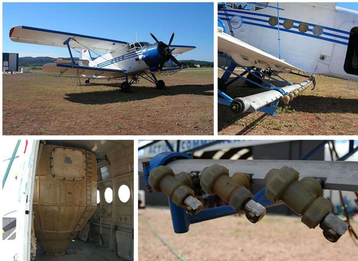
Figure 17. Avion d'épandage agricole (Antonov 2) (© Cedre).
