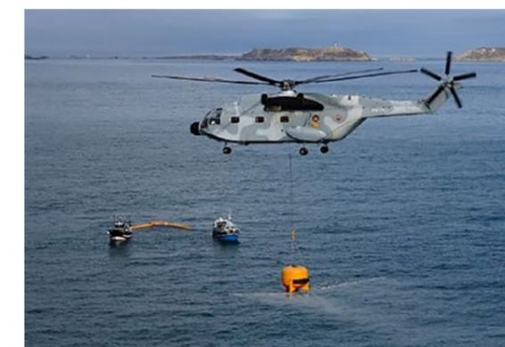
Figure 25. Cuve à dispersant héliportée utilisée lors d'un exercice Polmar-Terre/Mer dans les Côtes d'Armor (France) (© Marine française).
