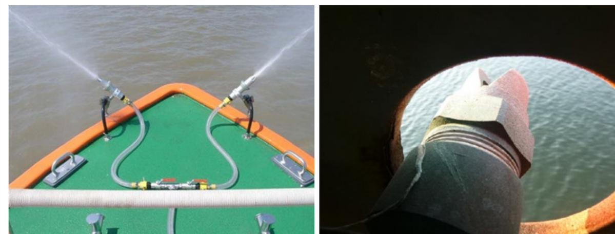
Figure 28. a) Lance à simple buse mobile (© Clean Caribbean & Americas), b) Système fixe intégré directement dans la coque du navire (© TotalEnergies).
