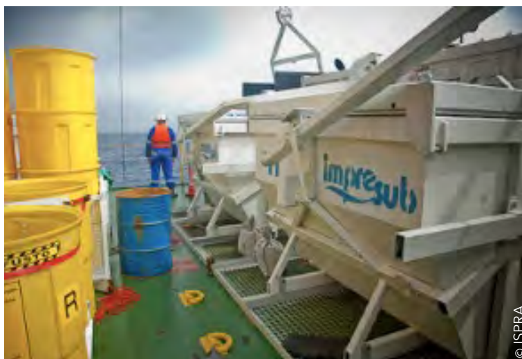
Racks spéciaux et surfûts conçus pour recueillir les fûts sur le fond marin
