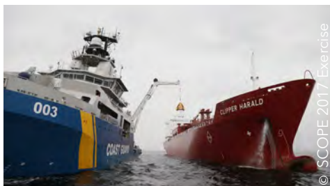
Navire d'intervention en mer spécialement conçu avec des capacités d'intervention en matière d'hydrocarbures et de HNS.
