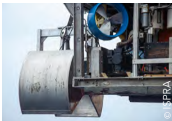
Échantillonneur à pince monté sur un ROV de Classe II
