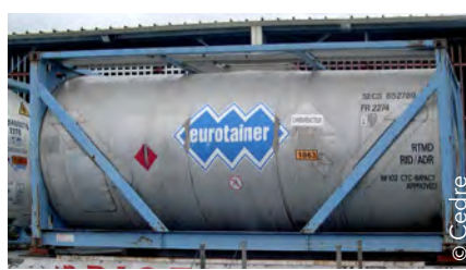
Réservoir ISO (conformité IMDG)
